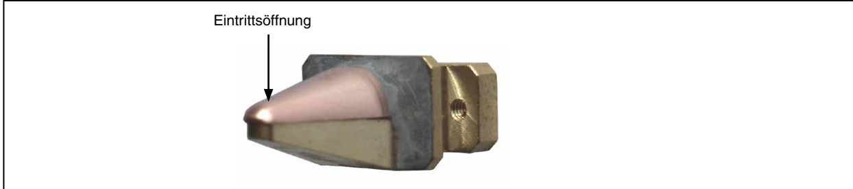
Abb. 14.4: Eintrittsöffnung (Pinhole) in der Messspitze
